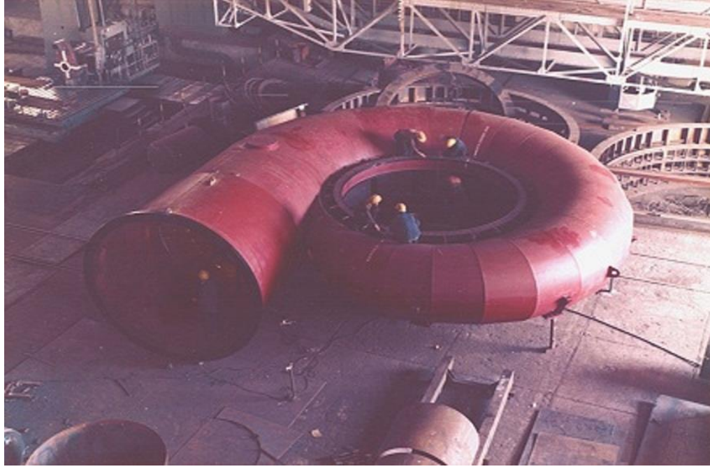
Fotoğraf 1. Salyangoz ve Hız Çemberi Komitesi (T.Ş.F.A.Ş. Ankara Makina Fabrikası). Alın bağlantılı dört parça ve Giriş Borusu olarak beş parça sevk edildi. Sevkiyat için demonte edilmeden önce. Arkada Stator Gövdeleri görülüyor (½ parça)
