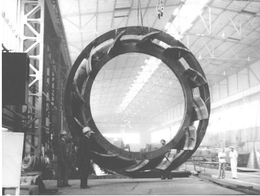
Fotoğraf 2. Hız Çemberi Yarı Parçası (imalat sürecinde, sabit kanatlar alt gövdeye monte edilmiş vaziyette).
