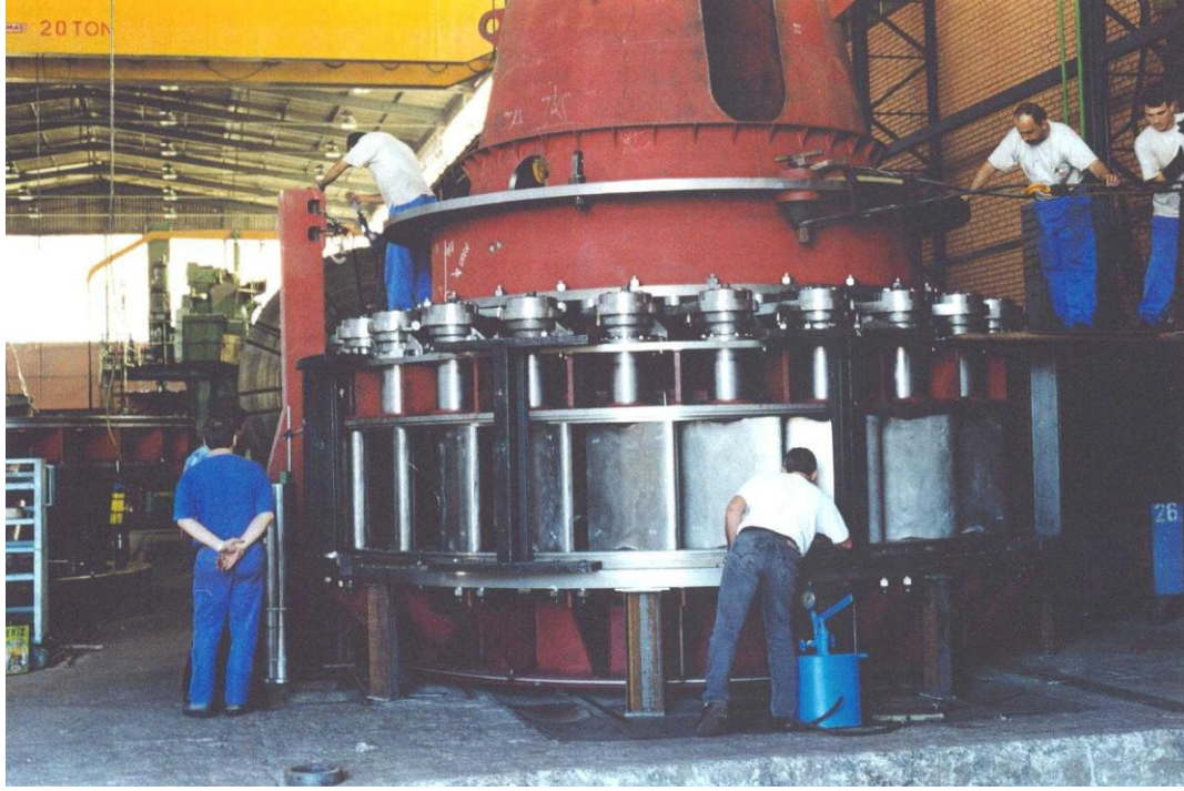
Fotoğraf 5. BERKE HES Dağıtıcı (distribütör) Grubu, test ve hassas ayar amaçlı atölye geçici montajı
