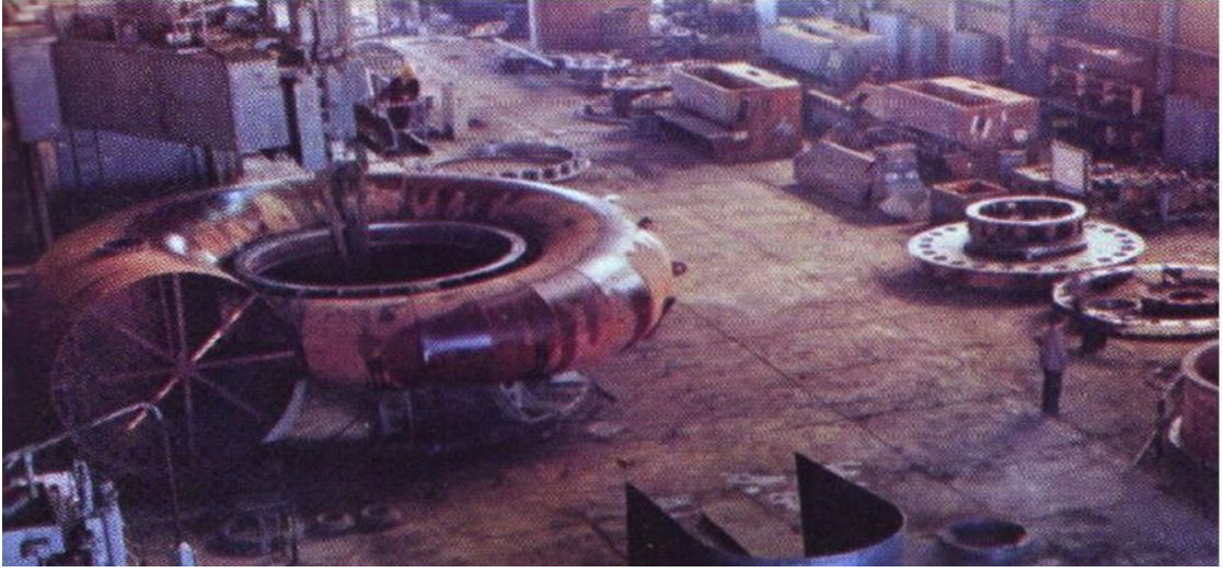
Fotoğraf 3. Salyangoz ve Hız Çemberi Kompleksi, Hız Çemberi iç çapı ve flanş yüzeylerinin torna işlemi. Sağ tarafta işlem için bekletilen Türbin Kapağı ve Aşınma Aynaları görülüyor.
